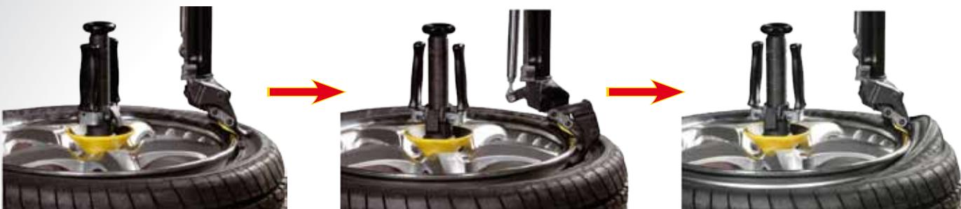
**IT** Gruppo di smontaggio e montaggio dove l'utensile è posizionato su un braccio mobile ad apertura laterale. Le operazioni sono garantite senza l'utilizzo della leva.
