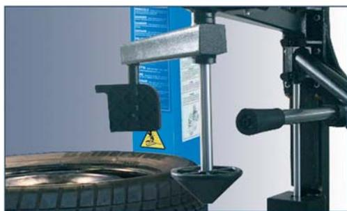
**Beweglicher Wulstniederhalter.** Drehbarer niederhalter, der den reifenwulst im Felgenbett hält.
