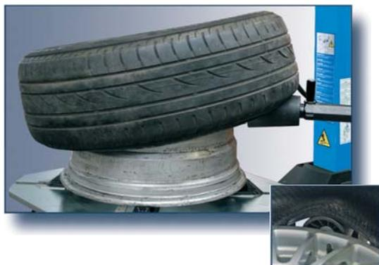
**Kegelrolle.** Vereinfacht die Arbeiten für die Demontage und Montage des ersten Wulsts, indem der Wulst im Felgenbett gehalten wird. Erleichtert die Demontage des zweiten Wulsts.
