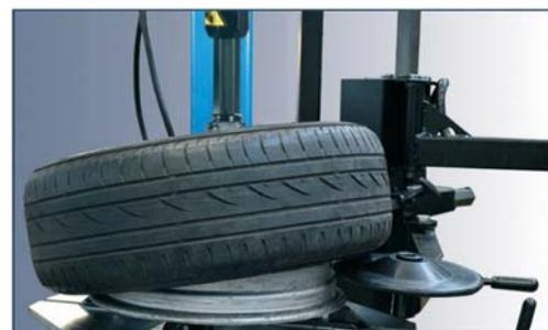
Die **grosse schein** gestattet das Anheben des Reifens und das Lösen des unteren Wulsts.
